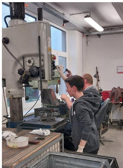
Die Kollegin vom FB Bildung und Soziales der Stadt Ludwigslust arbeitet an der Ständer-Bohrmaschine an einem Auftrag für einen Zaunelemente-Hersteller
